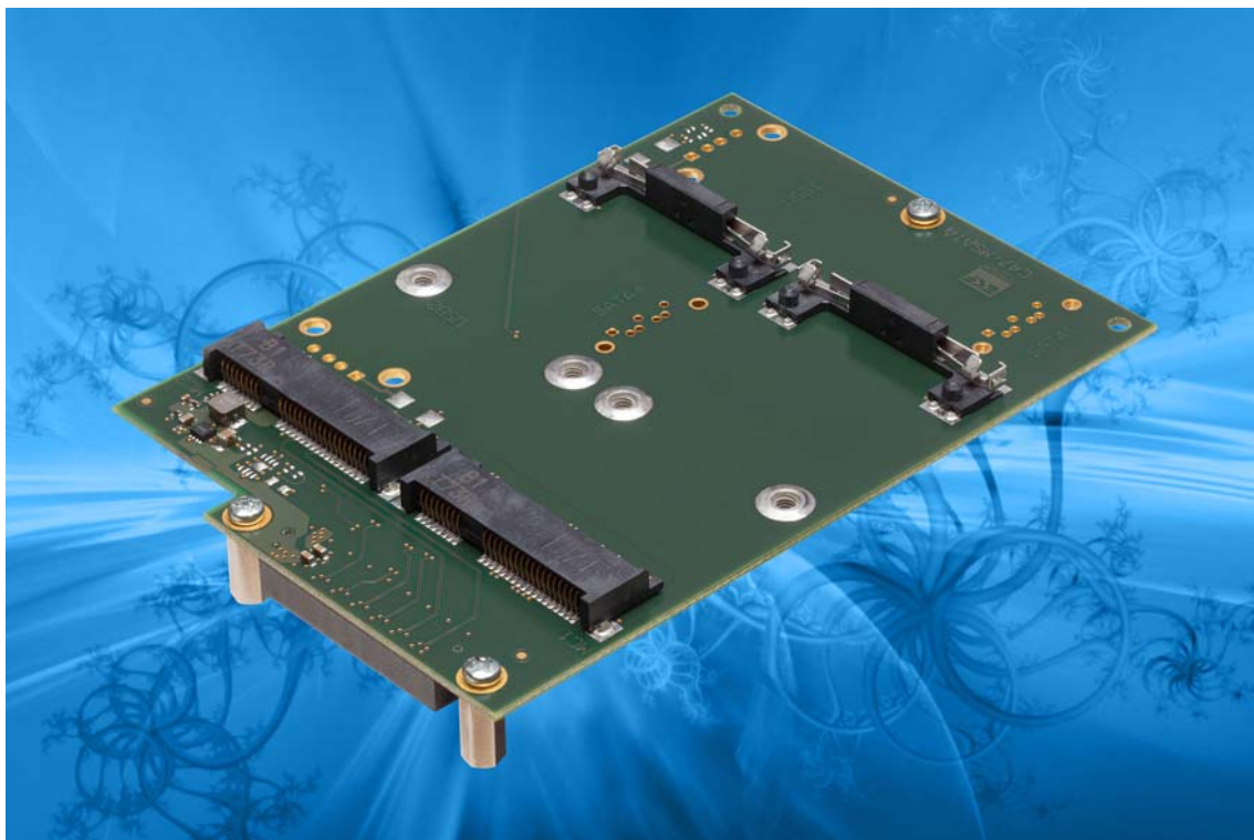
C47-MSATA • Mini Card Sockets (USB Type)
